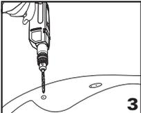
Taladre en los lugares marcados del lado interno de la bañera orificios Ø 3 mm, luego orificios Ø 8,5 mm. Taladre con máxima cautela, aplicando solamente una leve presión, en altas revoluciones, perpendicularmente a la bañera (en el eje de la rosca del arzón).
