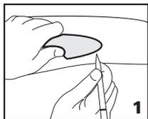
Na určenie najvhodnejšej polohy odporúčame prakticky odskúšať umiestnenie madla na vani. Madlo sa osadzuje na hornú plochu rozšíreného okraja vane.. Pružné madlo je možné presne dotvarovať na plochu vane. Priložte madlo do zvolenej polohy na vaňu a mäkkou ceruzkou označte na vani presný obrys dosadacej časti. Os madla by mala byť rovnobežná s radiusom vane, cca 30 mm od vonkajšej hrany
