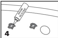
Antes de fijar definitivamente el arzón aplique masilla de silicone en vuelta del orificio del lado externo por bajo de la arandela.
