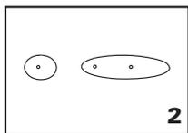
С трафарета снимите защитную пленку и приложите трафарет в намеченном месте к ванне. Выровняйте трафарет так, чтобы зазор между кривой на трафарете и кривой на ванне был одинаковым по всему периметру. **ВНИМАНИЕ:** шаблоны ассиметрические. Аналогично следуйте и на противоположном конце ручки. Намеченные отверстия визуально проверьте путем приложения к ним ручки.
