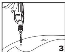
În locurile marcate pe interiorul căzii, dați găuri cu diametrul de 3 mm. Apoi lărgiți găurile până obțineți un diametru de 8,5 mm. Procedați cu atenție! Folosiți o bormașină cu variator.
