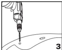
W oznaczonych miejscach wiercimy z wewnętrznej strony wanny otwory  $\varnothing$  3 mm, a następnie otwory  $\varnothing$  8,5 mm. Należy wiercić bardzo ostrożnie, nie używając dużej siły nacisku, przy wysokich obrotach prostopadle do wanny (w osi gwintu uchwyty).
