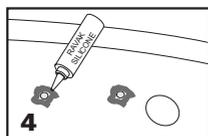
Înainte de așezarea finală a mânerului, puneți o mică cantitate de silicon pe partea exterioară a găurilor, sub șaibe.
