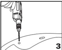
Au points marqués, forez les trous Ø 3 mm et puis les trous Ø 8,5 mm. Forez avec précaution, perpendiculairement à la baignoire (suivant l'axe du filetage de la poignée).
