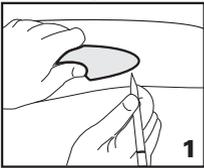
Nous recommandons d'essayer la meilleure position (hauteur, orientation) des poignées. La main courante se place sur la surface supérieure du bord élargi de la baignoire. Contournez d'un crayon la forme de la surface de contact de la poignée sur la baignoire. L'axe de la main courante devrait être parallèle au rayon de la baignoire, à environ 30 mm de l'arête extérieure.
