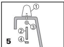
Приложите ручки и с внешней стороны их закрепите шайбой и гайкой М8. (Мелкие неточности расположения можно откорректировать увеличением отверстий максимально до Ø 10 мм!)
