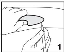
Pro zvolení nejvhodnější polohy doporučujeme prakticky odzkoušet umístění madla na vaně. Madlo se osazuje na horní plochu rozšířeného okraje vany. Pružné madlo lze přesně dotvarovat na plochu vany. Přiložte madlo do zvolené polohy na vanu a měkkou tužkou označte na vaně přesný obrys dosedací části. Osa madla by měla být rovnoběžná s radiusem vany, cca 30 mm od vnější hrany.
