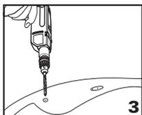
В намеченных местах высверлите с внутренней стороны ванны отверстия Ø 3 мм, затем отверстия Ø 8,5 мм. Сверлите аккуратно с применением небольшой силы, на повышенных оборотах дрели, перпендикулярно ванне.
