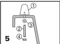
Adjunte los arzones y fíjelos del lado externo usando tornillos M8 con arandela. (Pequeñas imprecisiones de la medición pueden ser corregidas retaladrando los orificios a Ø 10 mm como máximo!)
