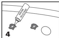
До момента окончательной установки ручек с внешней стороны ванны по периметру отверстий нанесите слой силиконовой замазки.
