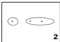
Ze šablony sejměte krycí papír a přiložte průhlednou samolepící folii na předkreslený tvar na vaně. Šablonu vyrovnejte tak, aby měla stejnoměrnou mezeru mezi tvarem na vaně a na folii po celém obvodu. POZOR: Šablony nejsou symetrické! Stejně postupujte i na druhém konci madla. Označené otvory překontrolujte ještě vizuálně přiložením madla k vaně.
