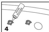
Před definitivním upevněním madla naneste okolo otvoru pod podložku silikonový tmel.
