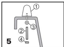
Priložte madla a z vonkajšej strany ich pripevnite skrutkami M8 s podložkou. (Malé nepresnosti merania môžete napraviť prevrtaním otvorov maximálne na  $\varnothing$  10 mm!)
